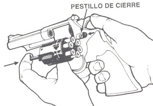
Para comprobar un revólver, abra el cilindro, extraiga las vainas/cartuchos y compruebe que todas sus recámaras se encuentran vacías. Compruebe por último el cañón del arma.
